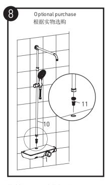
将连接头(11)安装在阀体(1)上, 然后将淋浴杆连接到阀体(1)
