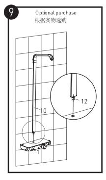
卸除保护盖(12)后,直接将淋浴杆连接 阀体(1)
