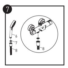
确保花洒软管(8)的两端都带有密封垫片(7)。将花洒软管的一端连接花洒(6),另一端连接阀体的花洒连接头。
